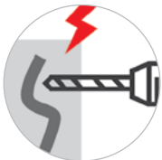
Механическое повреждение изоляции
